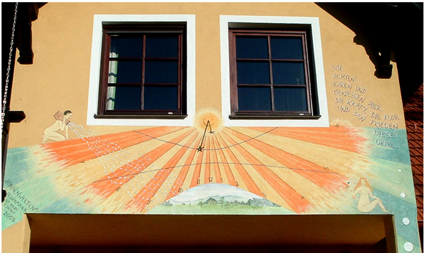
Fassade rechts im Detail: SonnenUhr des Auftraggebers: ein "bekennender Wassermann", der Sohn, eine "Jungfrau"; die Sonnenwenden bilden den unteren bzw. oberen Rand des Halb-Stundenfächers, mit Datumslinien der Geburtstage (30.Jänner & 05.September). Unter der SommerSonnWendLinie: "Spiegelung" des Horizontbildes als Landschaftsbezug
